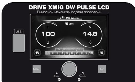
В памяти аппарата имеется 10 ячеек для хранения режимов сварки.
