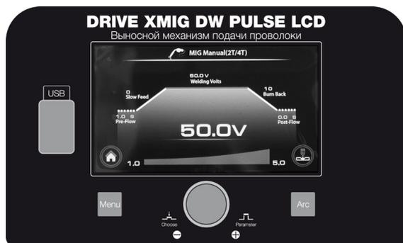
2. Выбор пункта на параметрической кривой: нажимайте регулятор 1 (Рис. 9.1) до выбора нужного пункта.
